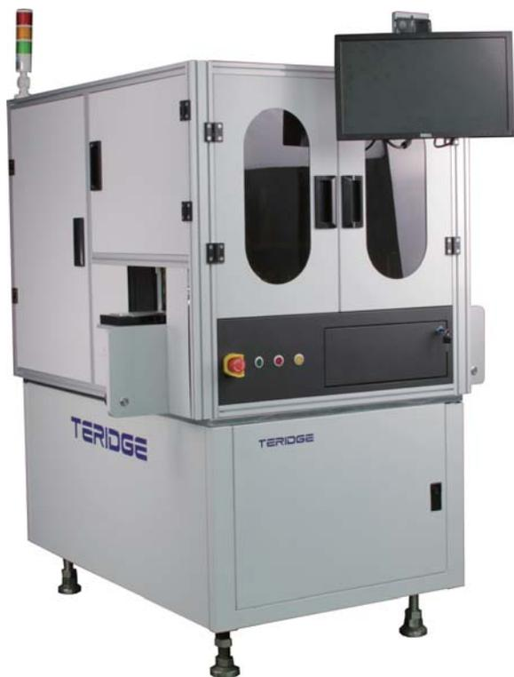
Teridge AC-2000设计用于智能手机的显示屏模组或玻璃背板点胶组装后溢出胶水的自动化擦拭处理。本设备使用四轴机械手用于控制擦胶轮和接缝的位置，适用于平面玻璃和3D玻璃。独特的即时压力监控和反馈设计，能够实时调整擦胶的压力，保证清洁的效果，并保证不损伤产品。
